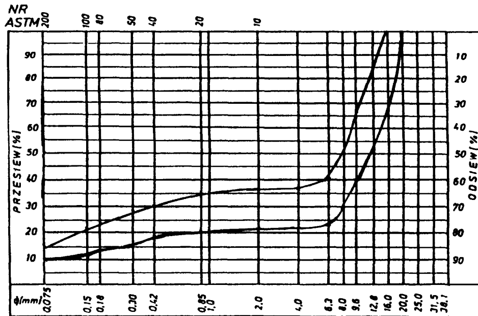
Rys. 5. Krzywe graniczne uziarnienia mieszanki mineralnej 0+20 mm o nieciągłym uziarnieniu do warstwy ścieralnej z betonu asfaltowego dla KR 3-6
